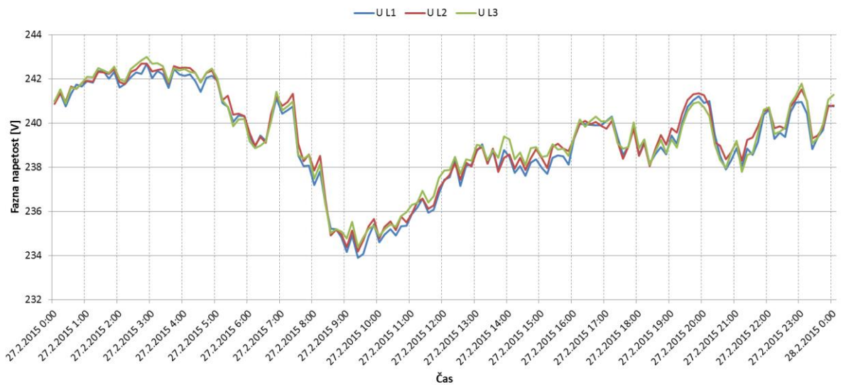
Slika 3: Napetosti v TP T1183 Šenturška gora kabelska (brez kompaundacije) – povprečne 10 minutne vrednosti.
