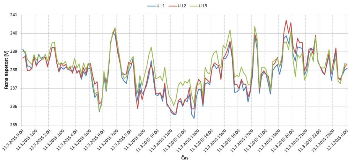
Slika 6: Napetosti v TP T1183 Šenturška gora kabelska (vključena kompaundacija) – povprečne 10 minutne vrednosti.
